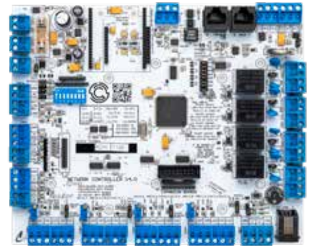
Network 4 Door Controller CSEVO4
