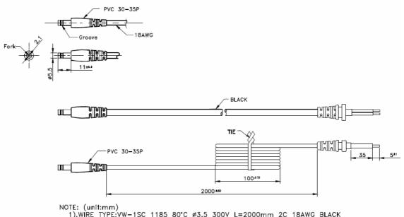
NOTE: (unit:mm) 1).WIRE TYPE:VW-1SC 1185 80°C Ø3.5 300V L=2000mm 2C 18AWG BLACK 2).WIRE JACKET MATERIAL:PVC (94V-0) 3).THE POLARITY: ⊖ • •
